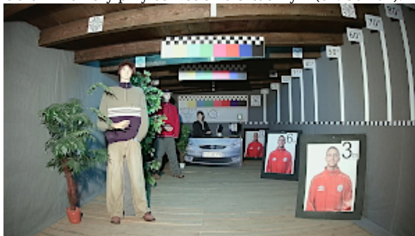
Obraz z kamery przy pracy w nocy z włączonym wbudowanym oświetlaczem LED:
