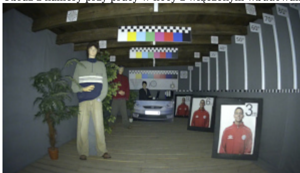
Obraz z kamery przy pracy w nocy z włączonym wbudowanym oświetlaczem IR:
