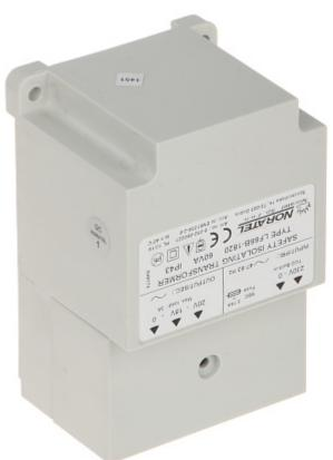
Jednofazowy transformator bezpieczeństwa z wbudowanym zabezpieczeniem przeciwzwarciowym i termicznym, zaprojektowany został i wykonany według normy EN61558-2-6. Uzwojenia są separowane i zalane masą poliuteranową w samogasnącej obudowie.
