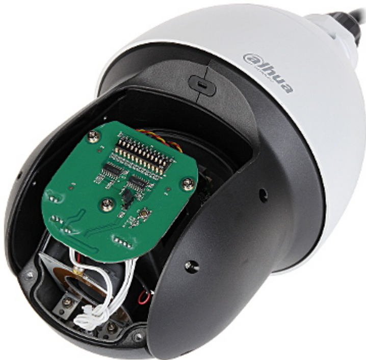
Kamera od spodu (widoczne przełączniki konfiguracyjne):
