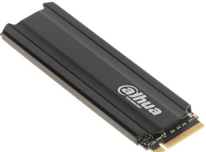
1 TB Pojemność: M.2 Typ złącza: Rozmiar: 2280 PCIe 3.0 x4, NVMe 1.3 Interfejs: Prędkość zapisu: 1600 MB/s Prędkość odczytu: 2000 MB/s 1 500 000 h MTBF (średni czas pomiędzy awariami): ≤ 512 TB TBW (całkowita liczba zapisanych bajtów): • Pamięć 3D TLC NAND Flash • S.M.A.R.T
