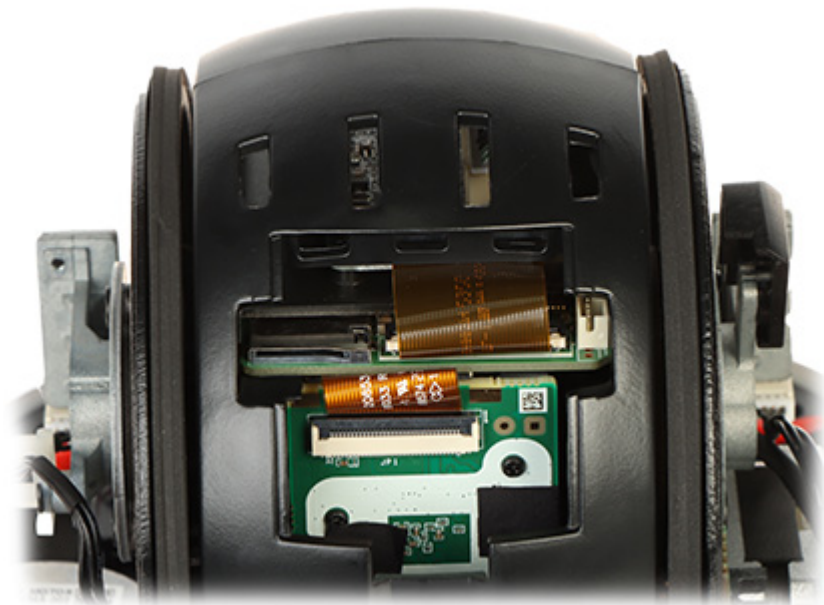
Gniazdo Micro SD znajduje się wewnątrz kamery:
