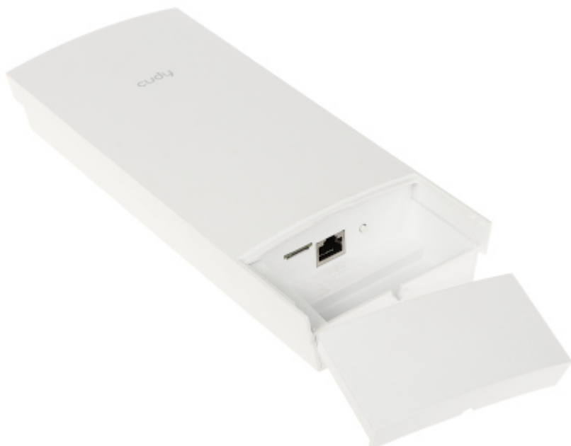
Gniazdo karty nano SIM, złącze Ethernet oraz przycisk RESET
